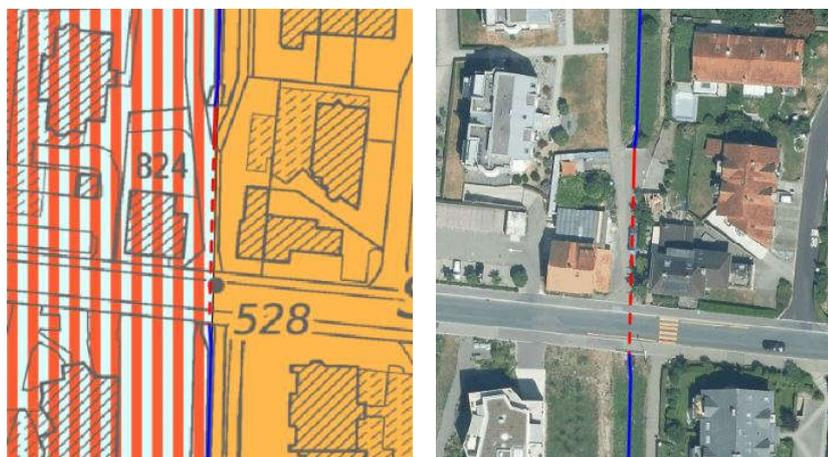
Abbildung 57: Darstellung des Abschnitts Fr\_02 mit dem Verlauf der Eindolung rot eingezeichnet auf dem Zonenplan des ÖREB-Katasters (links) und Orthofoto (mitte).
