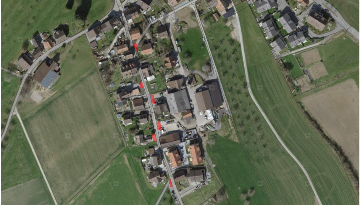
Abbildung 15: Oberdorfstrasse (südlicher Abschnitt) mit Ausweichstellen (gisknonaueramt.ch)
